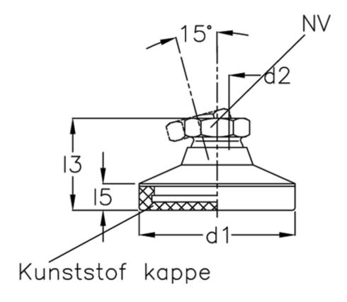
d1 = 50 d2 = 10 l3 = 29.5 l5 = 8.5 NV = 15 Static load (N) = 20 t min = 10.5
